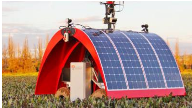
Figura 7.10 Robot integrado de paneles de captación de energía solar, cámaras y herramientas de mediciones, en huerta de legumbres
